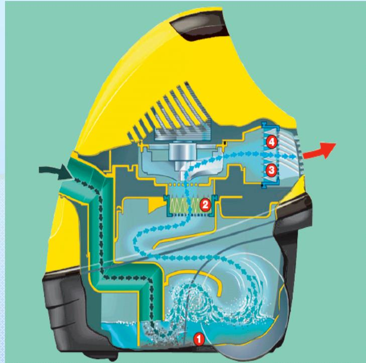
Die Wirkung des Kärcher Wasserfiltersaugers
